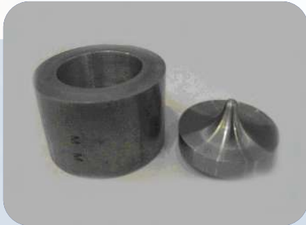
Bloco de lapidação em "Ferro Fundido" para a Lapidação do Disco com Defletor
