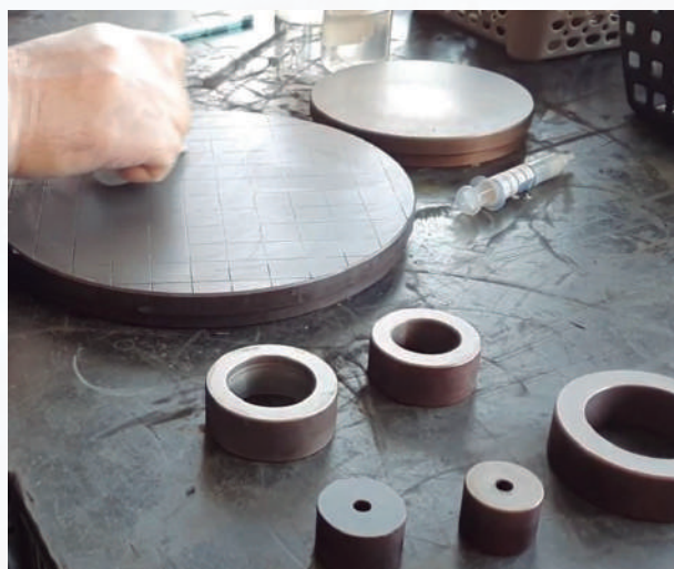
Figura 2 - RECONDICIONAMENTO DE BLOCOS DE LAPIDAÇÃO
